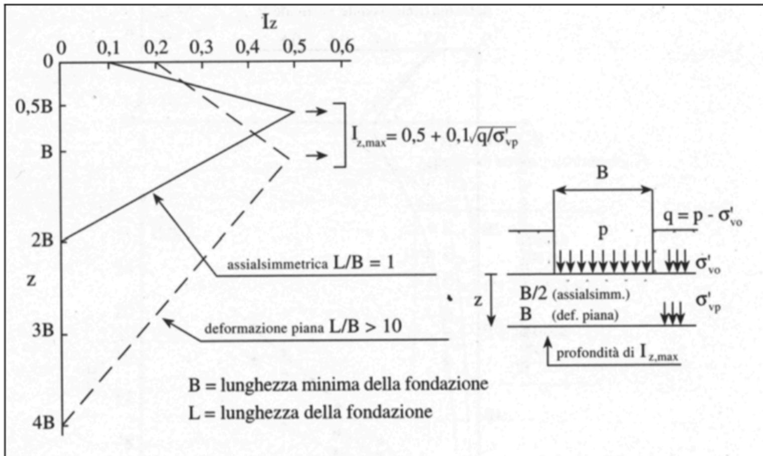
Figure 22. Strain Factor (Schmertmann et al., 1978)
